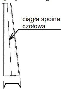
Rys. 8. Pale specjalne wykorzystywane do zniwelowania pochylenia ścianki
