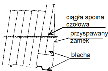
Rys. 8. Pale specjalne wykorzystywane do zniwelowania pochylenia ścianki
